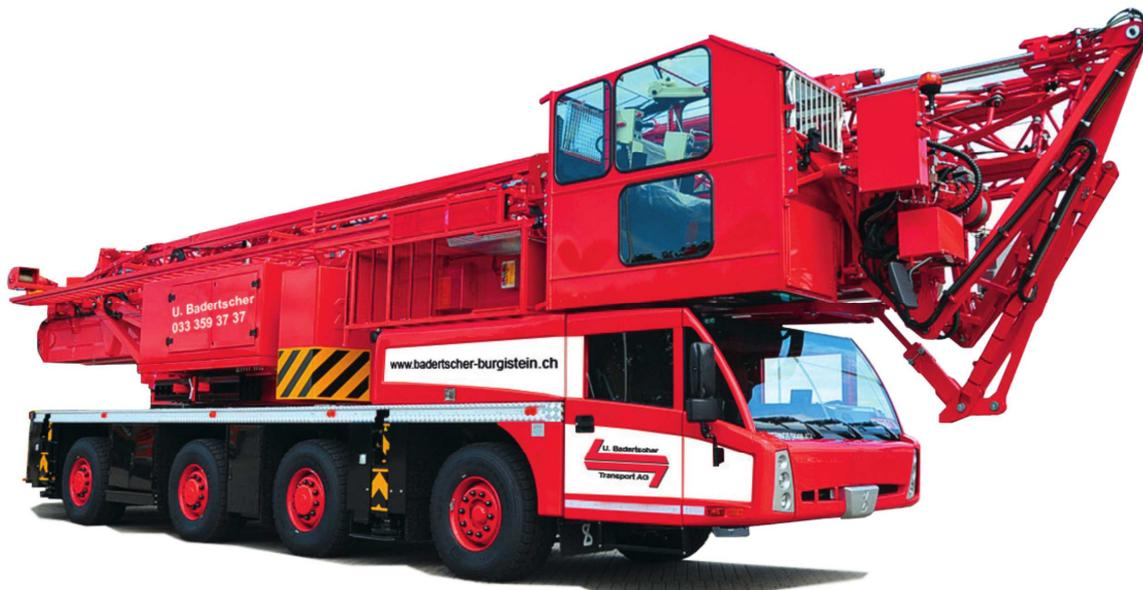
Unser Falkkran Spierings SK498-AT4 verbindet die oft benötigte Mobilität eines Autokrans mit der Funktionalität eines Baukrans. Mit einer maximalen Ausladung von 44m und einer maximalen Hublast von 8 Tonnen ist er den vielfältigsten Anforderungen gewachsen.
