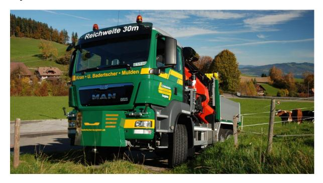
Mit unserem wendigen 53mto Kranwagen mit einer Reichweite von 30m können auch enge Abladeorte angefahren werden. Dieser Kranwagen ist mit einem Arbeitskorb und einer 2.5 Tonnen Seilwinde ausgerüstet. Der Zusatzknickarm hat eine Hubkapazität von 3.3 Tonnen. Besonders geeignet für
